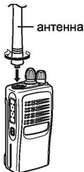
Навинтите антенну на разъем сверху радиостанции, удерживая антенну за основание и вращая ее по часовой стрелке до отказа.
