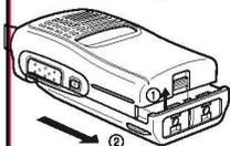
Для снятия аккумулятора отодвиньте защелку и сдвиньте аккумулятор с радиостанции.
