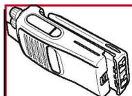
Надвиньте аккумулятор на заднюю часть радиостанции до защелкивания фиксатора в нижней части радиостанции.
