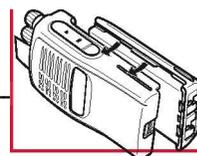
Сопоставьте 4 канавки на аккумуляторе с четырьмя направляющими на задней стороне радиостанции.
